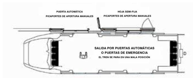
El módulo de la puerta se compone de 2 puertas automáticas (lado izquierdo y lado derecho). Cada una de ellas es arrastrada por un potente operador DIVA, adaptado para este tipo de proyecto específico.
