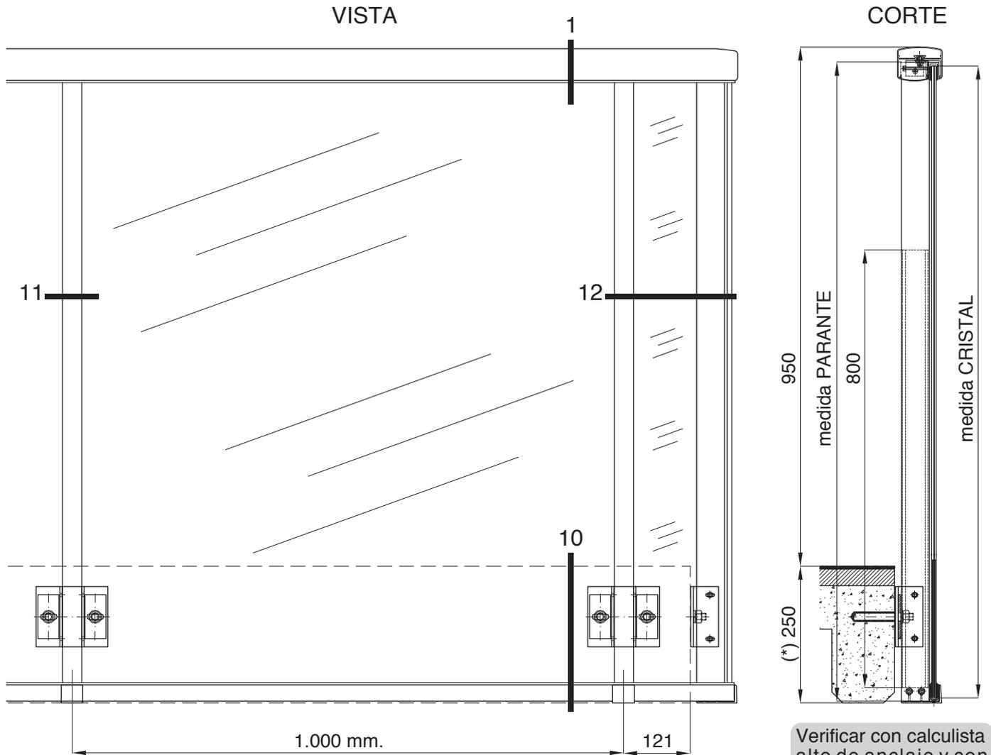
Verificar con calculista alto de anclaje y con fabricante anclaje químico aplicación sobre hormigón.
