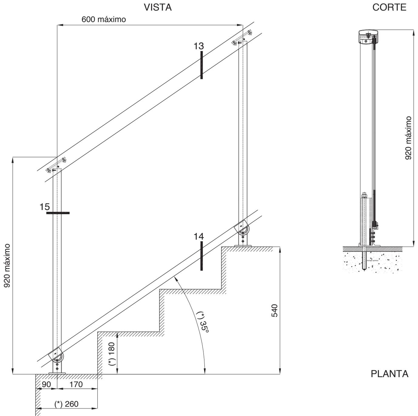
(\*) Muy importante: tener en cuenta las medidas del escalón y pendiente de escalera para un óptimo posicionamiento del anclaje.
