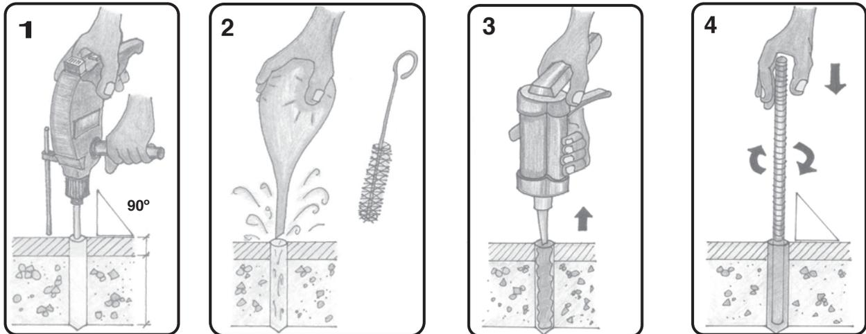
1. Taladrar un orificio de 14 mm. de diámetro y una profundidad de 100 mm., esta medida no incluye revestimientos sobre hormigón como contrapiso, cerámicos, etc. Se recomienda durante la operación mantener la perpendicularidad de perforación con respecto al piso.
